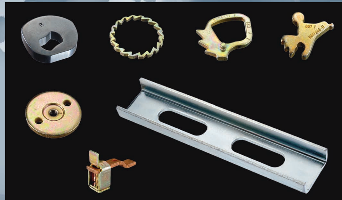
■ STANSNING OCH BOCKNING Normalstansning, finstansning. Med finstansning kan man få fina snittytor och även förskjuta material för olika funktioner.
